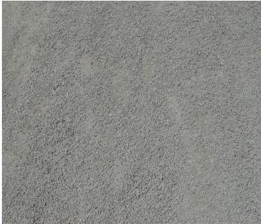
Agregado fino que se obtiene a partir de la explotación, trituración y clasificación de áridos extraídos de la cantera, siguiendo altos estándares de calidad, para garantizar la homogeneidad del material producido en cuanto a sus características físicas y de distribución granulométrica.
