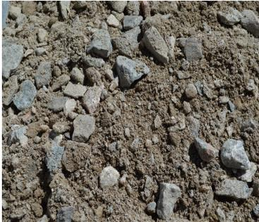
Material granular de proporciones finas y gruesas que se obtiene a partir de la explotación, trituración y clasificación de áridos extraídos de la cantera, siguiendo altos estándares de calidad, para garantizar la homogeneidad del material producido en cuanto a sus características físicas y de distribución granulométrica.
